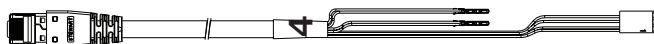
10: 1 X Quest / Flex - Chorus リザーバー - Chorus ディスペンサーケーブル - SP1227 (650mm)
